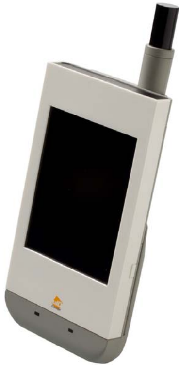
写真 1. 携帯型 UWB 基地局 (UC に装着した状態)
